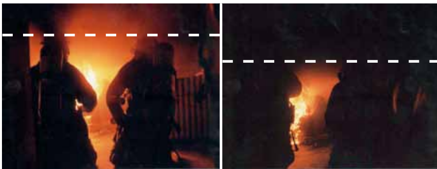
Obniżanie się płaszczyzny neutralnej w miarę rozwoju pożaru do rozgorzenia
