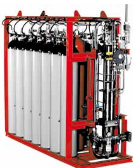
↑ Rys. 2. Zespół pompowy z napędem za pomocą sprężonego gazu obojętnego składowanego w butlach (szare butle) (na przykładzie zespołu pompowego urządzenia gaśniczego mgłowego typu HI-FOG GPU firmy Instac)
