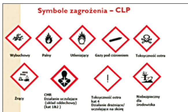
Rys. 2. Piktogramy zagrożenia są umieszczane na etykietach niebezpiecznych substancji i mieszanin chemicznych określonych przez rozporządzenie CLP wg A. Obuchowskiej, Wojewódzka Stacja Sanitarno-Epidemiologiczna w Gdańsku
