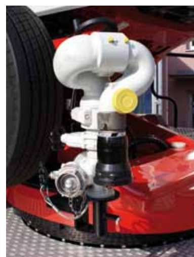
↑ Podczas transportu działko wodno-pianowe przewożone jest na obrotnicy
