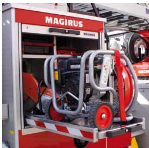
↑ Jedną ze skrytek sprzętowych mieści wentylator oddymiający i piłę mechaniczną
