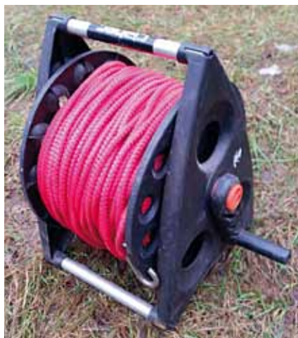
Lina o dodatniej pływerności zamontowana na kołowrocie
