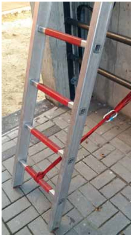
Mechaniczne zabezpieczenie drabiny przenośnej
