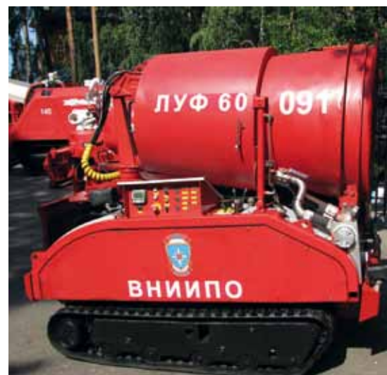
u góry od lewej: Rosyjskie roboty wyposażone w system do zraszania dużych powierzchni [7], bezzałogowa Platforma Lądowa Strażak obok: Zestawienie systemów BPL Strażak [9]
